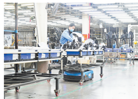
在南昌华翔汽车内外饰件有限公司生产车间内,智能AGV小车正在车间内运送物料。2022年,南昌华翔5G+智慧工厂项目稳步推进,预计下半年正式投入使用。项目上线后,可实现生产过程透明、物流通透,通过可视化数据,盘点数据准确率提升20%、生产计划准确率提升10%。
