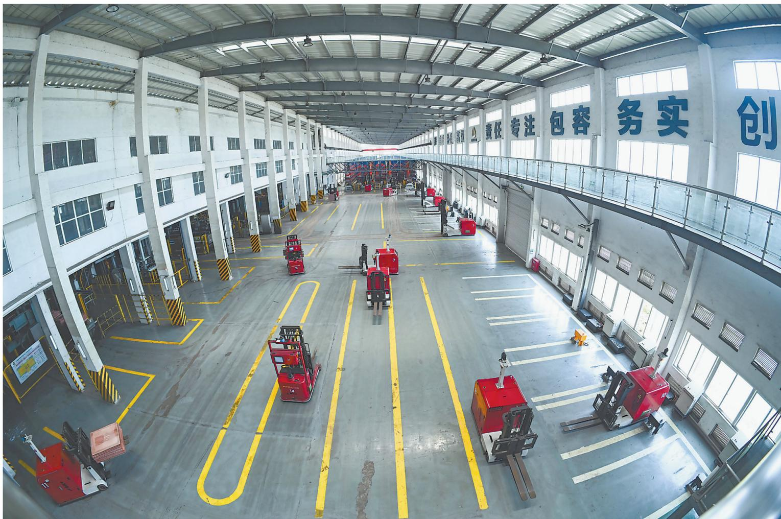
7月22日,在江铜集团贵溪冶炼厂智能工厂车间,智能无人叉车在运输阴极铜产品。数字化运作和管理,在提升工作效率的同时,也降低了工作强度。
