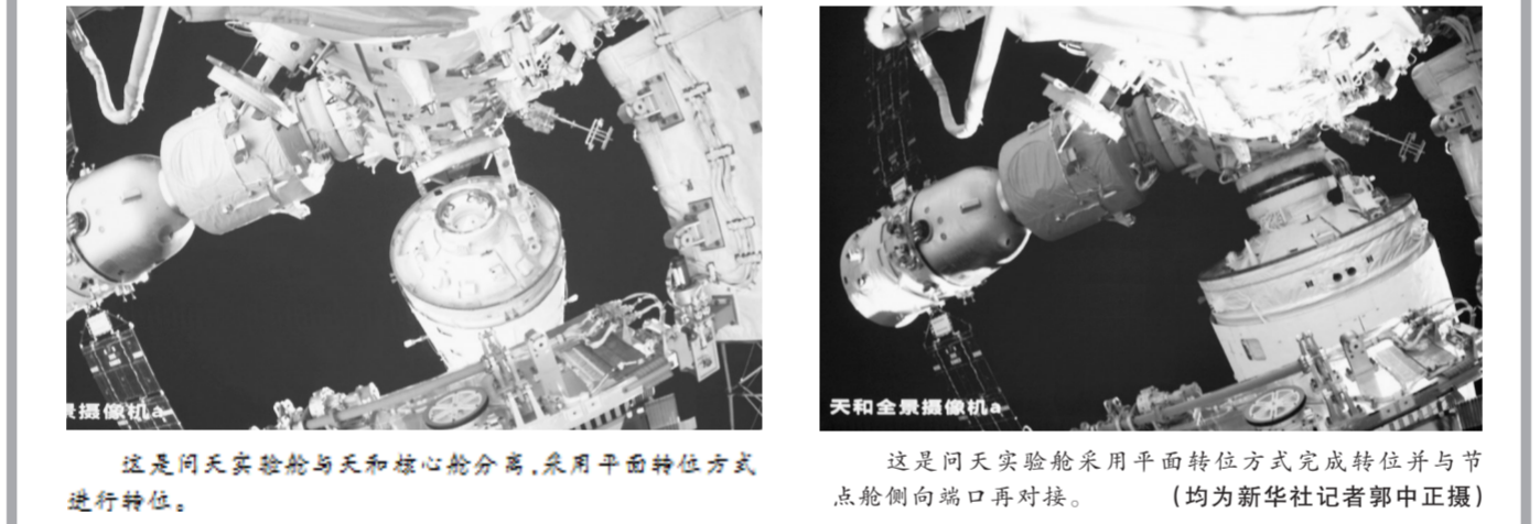
这是问天实验舱与天和核心舱分离，采用平面转位方式进行转位。这是问天实验舱采用平面转位方式完成转位并与节点舱侧向端口再对接。(均为新华社记者郭中正摄)
