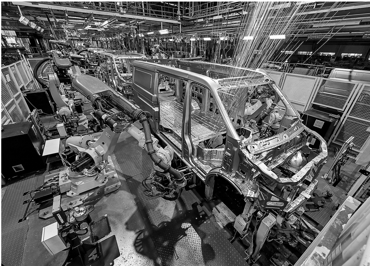
2月8日，在山东凯马汽车制造有限公司赣州分公司冲焊车间，全自动机器人正在生产线上进行焊接作业，赶制新能源汽车订单。目前，赣州新能源汽车产业集群已聚集新能源汽车及零部件生产企业120余家，其中规模以上企业48家。
