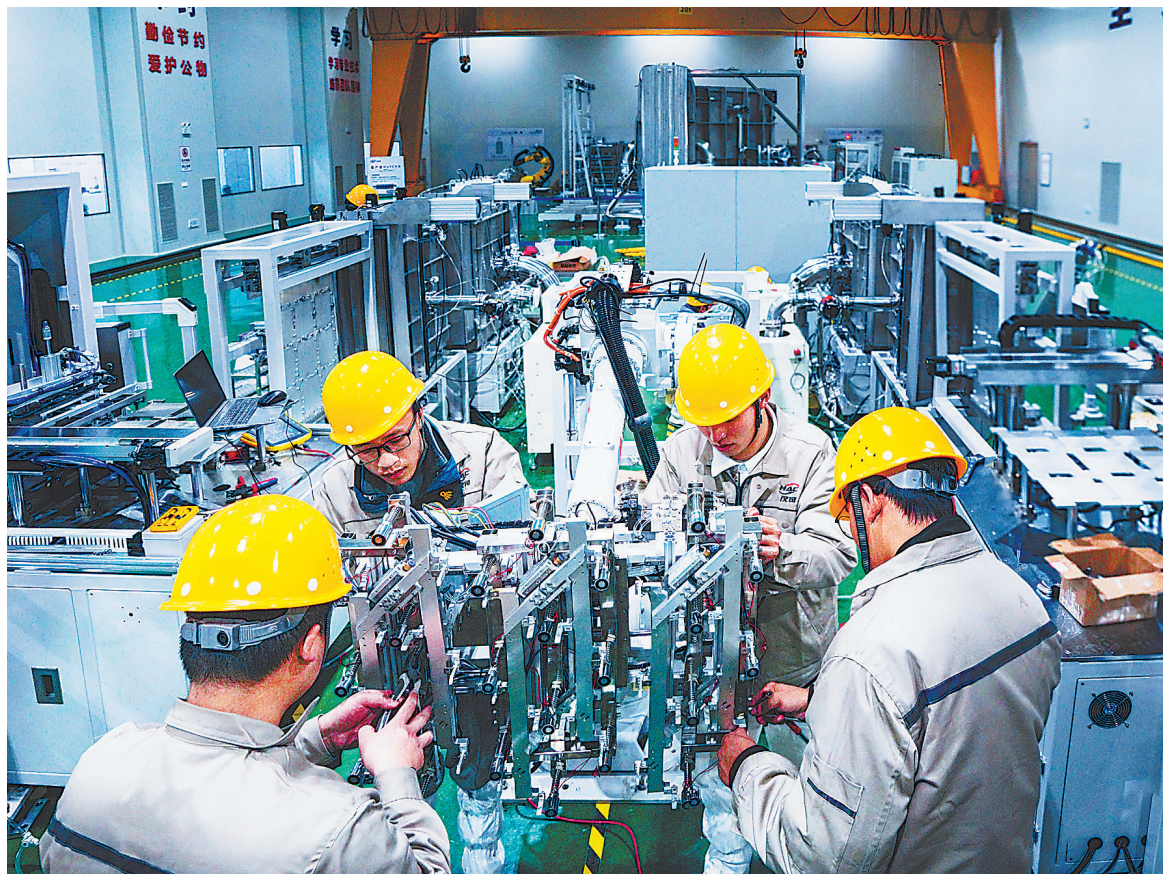
2月17日，位于共青城市的江西汉可泛半导体技术有限公司内，员工在安装热丝CVD设备。据了解，该公司完成国内首套500MW大产能光伏用半导体镀膜热丝CVD设备及智能传料系统，实现了该项技术国产化，且各项性能指标全面领先，拥有核心技术专利30余项。
