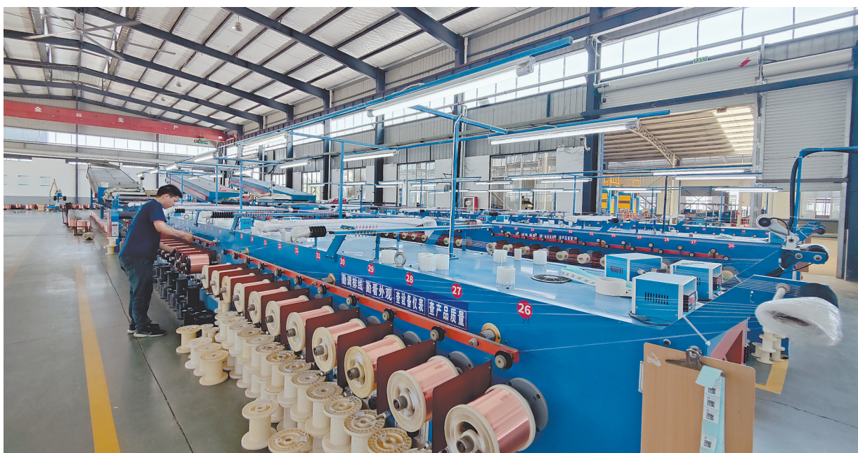
在位于鹰潭高新区的鹰潭中新材料有限公司智能化生产车间内,工人在检查高速运转的拉丝设备。
