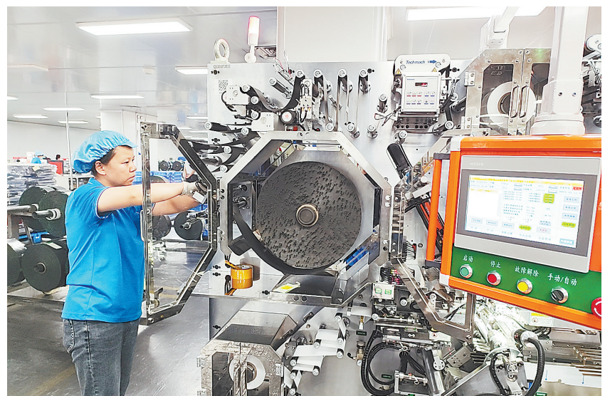
6月19日,位于永新工业园区的江西昊新新能源有限公司生产车间内,工人正在操作锂电池智能全自动卷绕机。近年来,该县持续优化营商环境,落实落细惠企政策,引导企业转型升级,提升企业智能制造水平。 本报全媒体记者 董文涛摄
