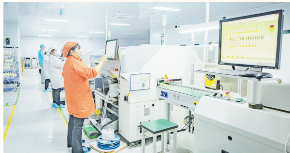
江西捷快通讯技术有限公司PCBA表面贴片车间
