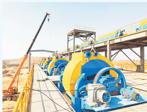
金环磁选主打产品高梯度磁选机应用于刚果金铜钴矿筛选类别
