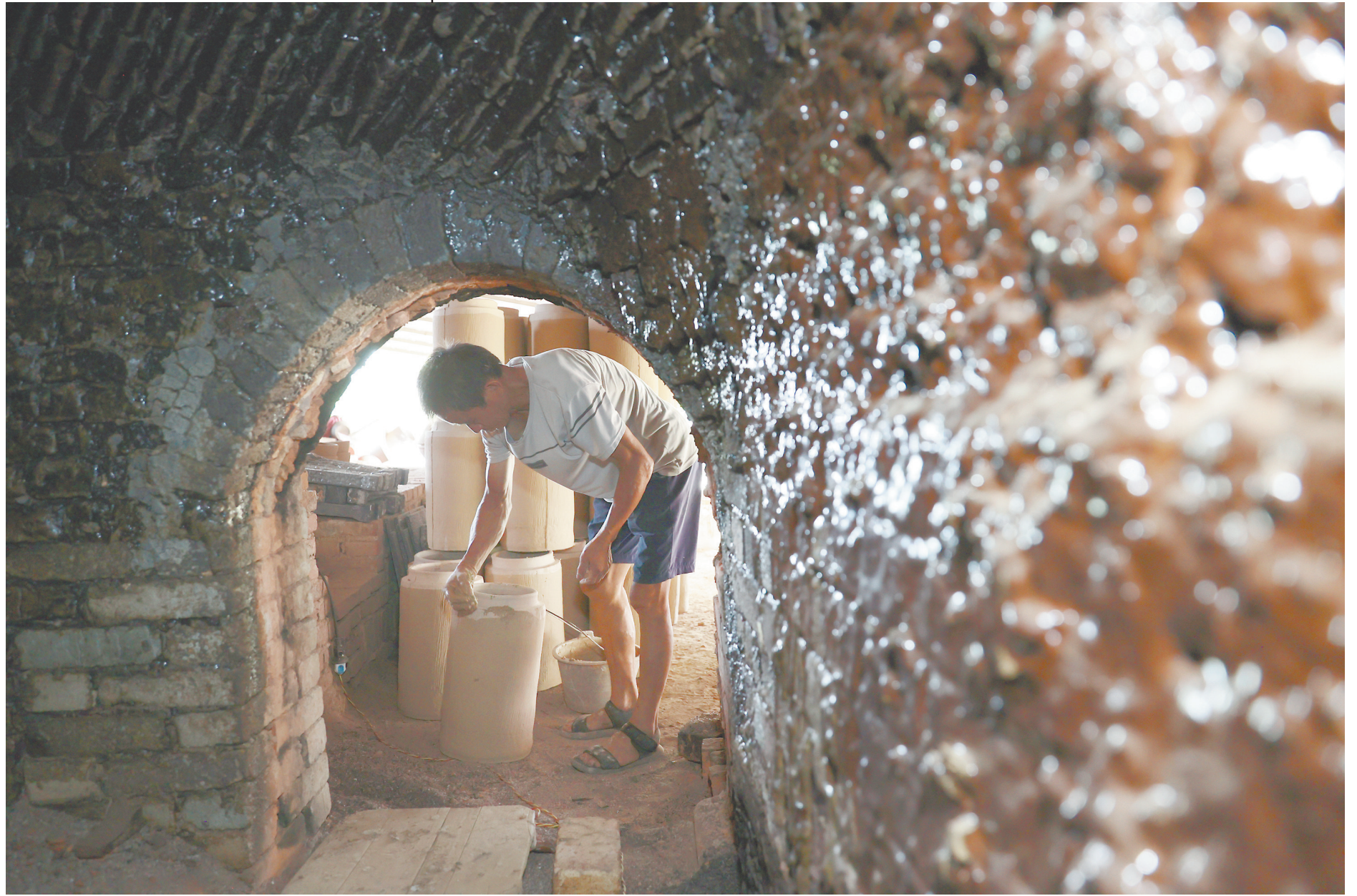
8月2日，洪州窑碗泥岭青瓷传承基地，窑工在对陶瓷坯胎进行制作、晾干、施釉后，将瓷坯一件件装入窑炉中备烧。
