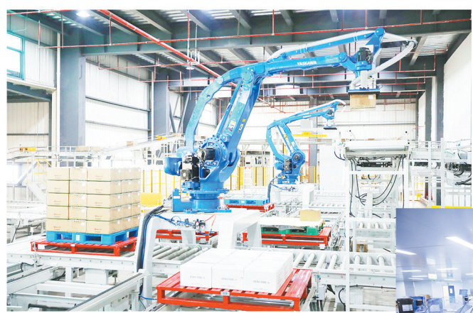
在江西永冠科技的智能立体仓库，机器人正进行机械码垛作业
