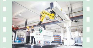
江西宇宙电路板设备有限公司生产车间内，工作人员正操控机器人手臂进行精细的焊接作业
