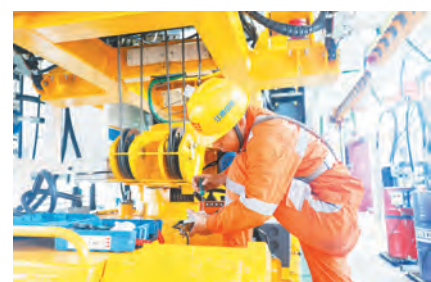
在江西中铁工程装备有限公司，工作人员正对粤海环北2号盾构机进行最后调试
