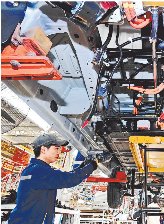
1月1日,赣州经济技术开发区的一家新能源汽车制造公司车间内,员工在安装出口南美洲的新能源电动汽车锂电池包。该开发区通过新能源项目带动制造业提质增效和转型升级,不断推进新型工业化。 特约通讯员 朱海鹏摄
