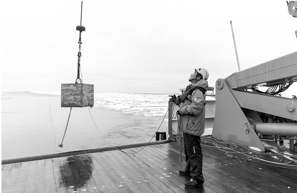
▶北京时间1月6日，布放潜标进入最后工序，考察队员沈忱准备下放重块。
