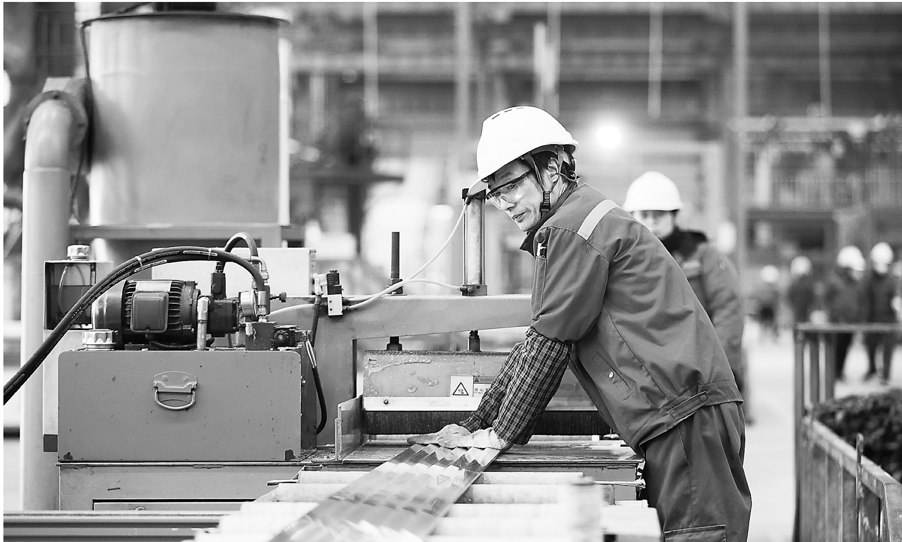
1月25日，位于铅山县的瑞旭实业有限公司厂房内，工人正在生产用于光伏支架的铝型材。该企业是集铝型材、电缆线、汽车配件、光伏支架、模具研发、销售与服务于一体的大型智能制造企业，去年全年产值达18亿元。
