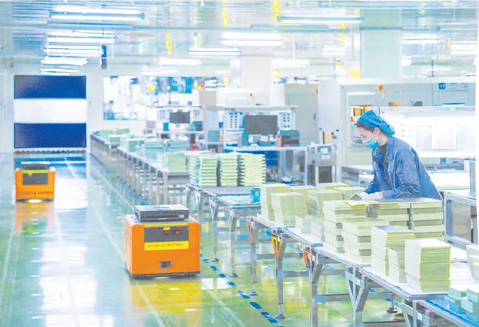
江西景旺精密电路有限公司，AGV机器人正在进行自动化作业
