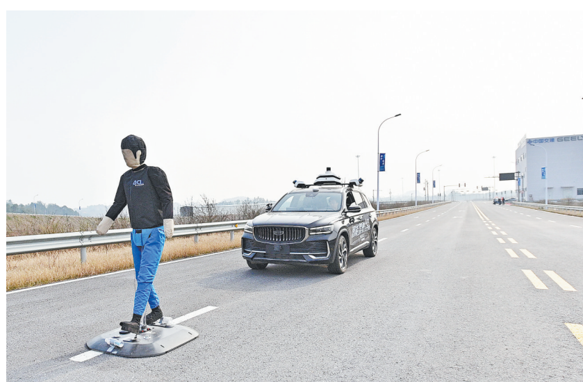
3月11日,车辆正在进行日常驾驶和紧急制动测试。
