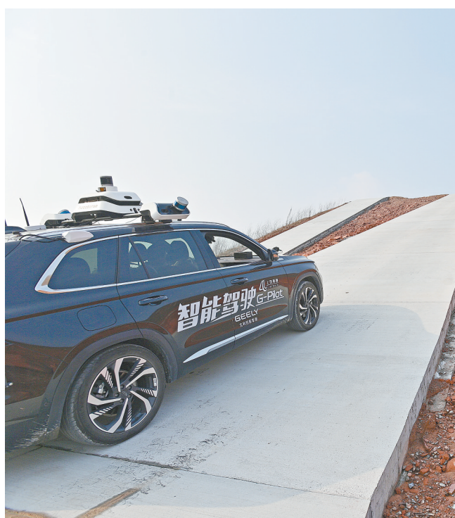
3月11日,江西上饶汽车试验场智能网联测试区,工作人员在对车辆进行5G远程遥控驾驶测试。
