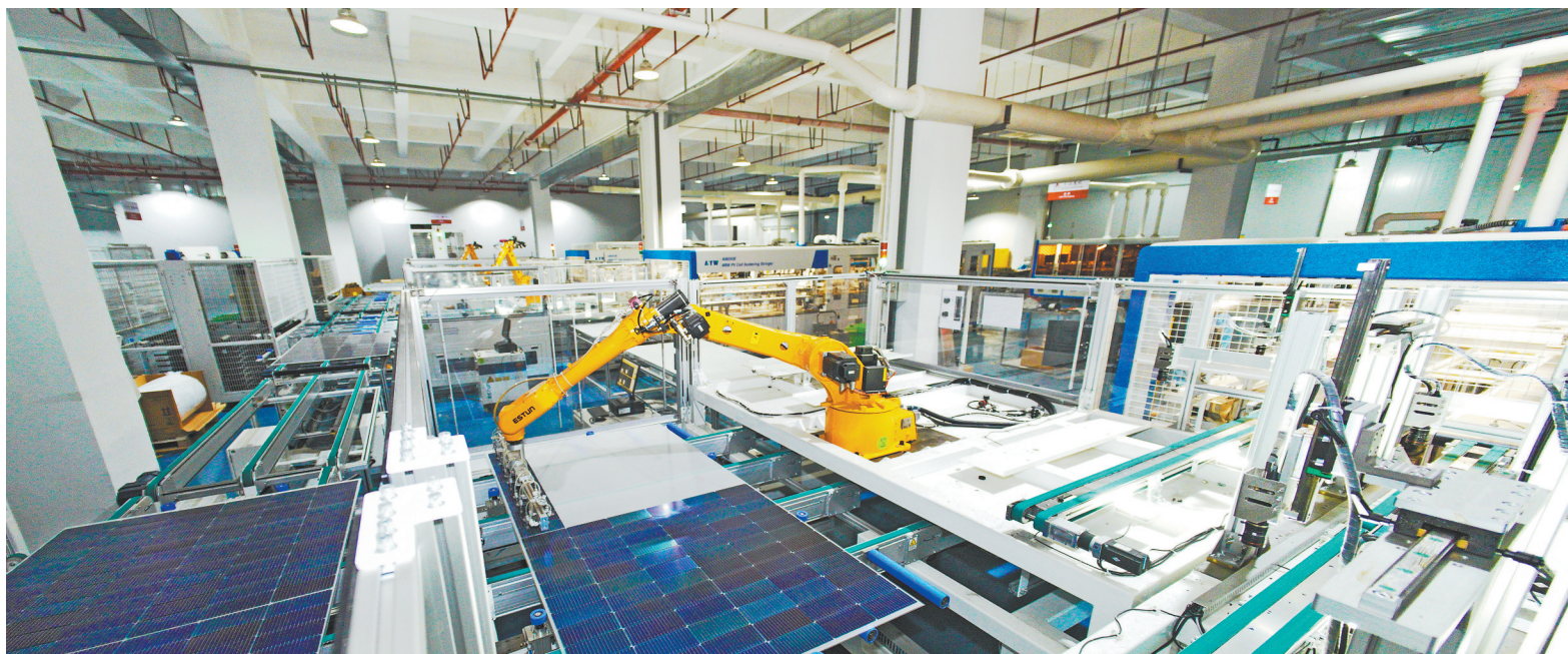
3月27日，位于萍乡市湘东工业园的江西仁江光伏有限公司生产车间，智能机器人正在进行光伏组件环节中的排版工作。近年来，湘东区以科技创新推动新质生产力发展，大力培育专精特新“小巨人”企业，助推工业经济高质量发展。 本报全媒体记者 史港泽摄
