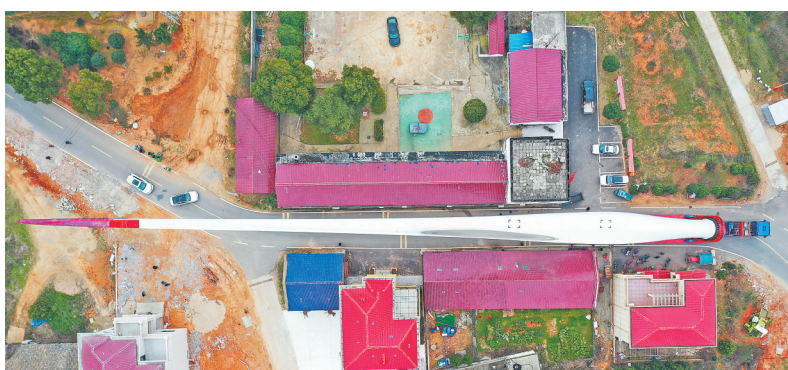
风机叶片运输路过高安市祥符镇东岗村时，工人通过上下左右调节叶片的角度，进行有效避让。
