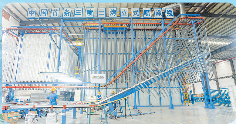
虹鑫铝业的国内首条三喷二烤立式喷涂线正在有序生产铝型材
