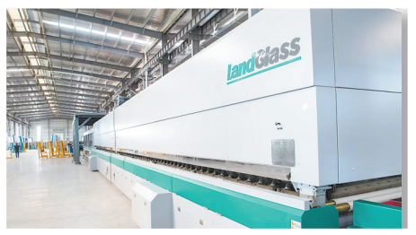
博信玻璃全自动钢化炉,大大提高了玻璃钢化效率。
