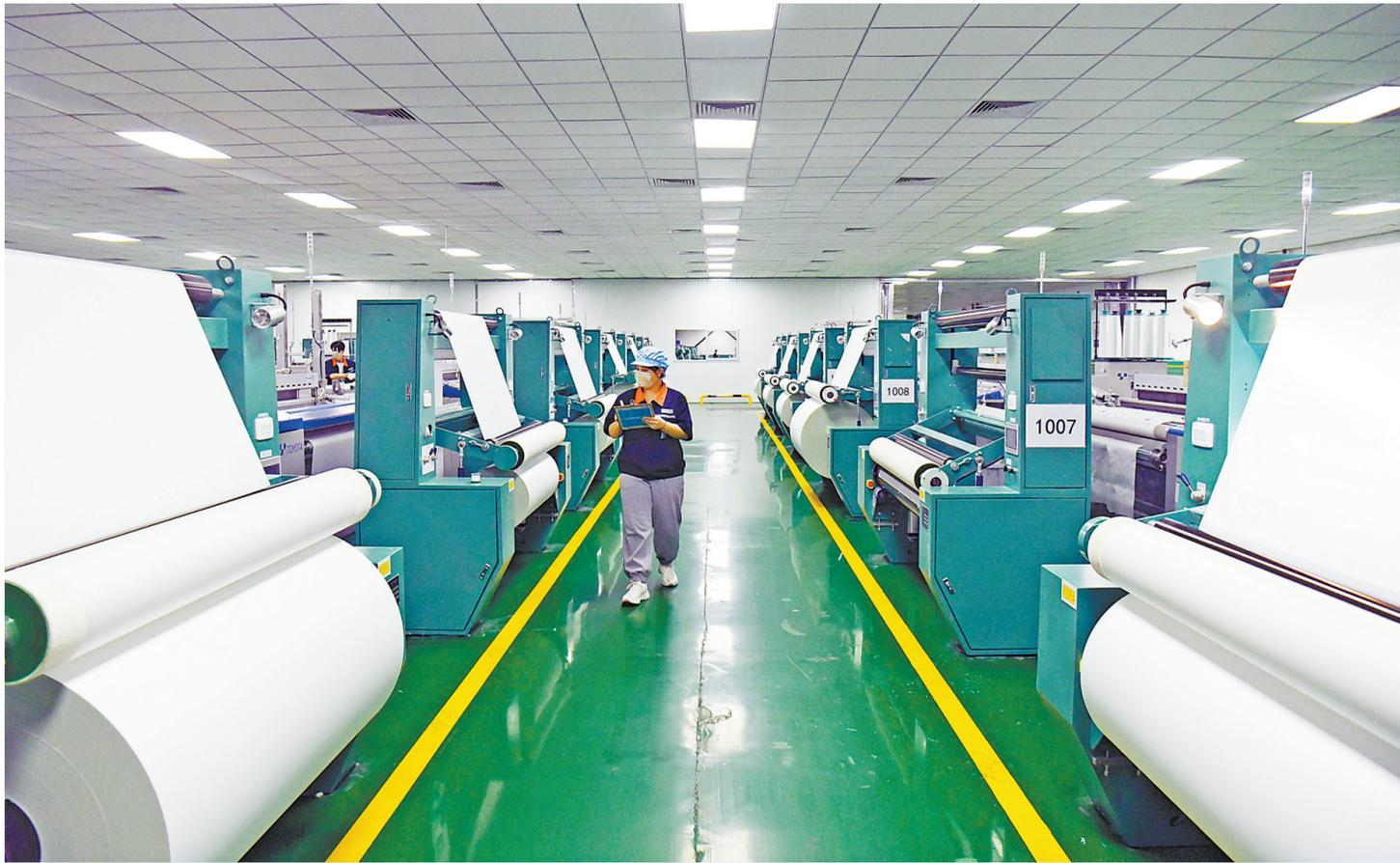
上犹县为加快打造玻纤新材料产业集群区，出台制造业重点产业链现代化建设“3315”行动计划，推动产业集群发展。图为5月15日，位于上犹县工业园区的江西星科电子材料有限公司生产车间内，喷气织布机（电子级玻纤布专用）正在进行玻纤织布作业。
