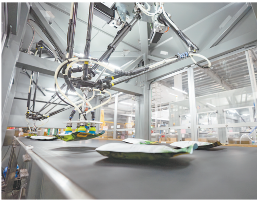
在甘源食品股份有限公司生产车间，并联蜘蛛手正在自动抓取产品装箱。
