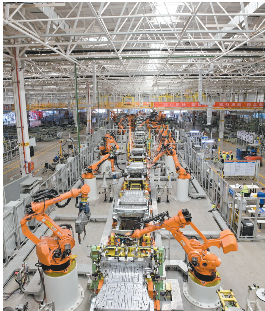
7月9日,在江铃集团新能源汽车有限公司焊接生产线上,机械臂按照设定程序进行焊接作业。
