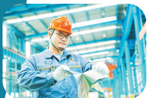
成功轧制世界最薄无取向电工钢，实现1250毫米宽幅0.1毫米超薄无取向电工钢全流程生产。图为员工展示“手撕钢”。
