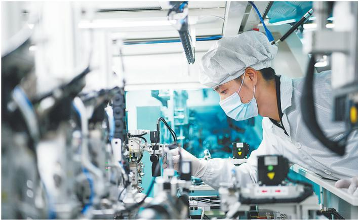
工人正在江西晶华微电子有限公司厂房调试全自动FOG机器检测液晶显示屏
