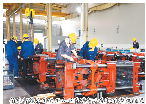
伯乐智能公司的工人正在进行注塑机的整机组装
