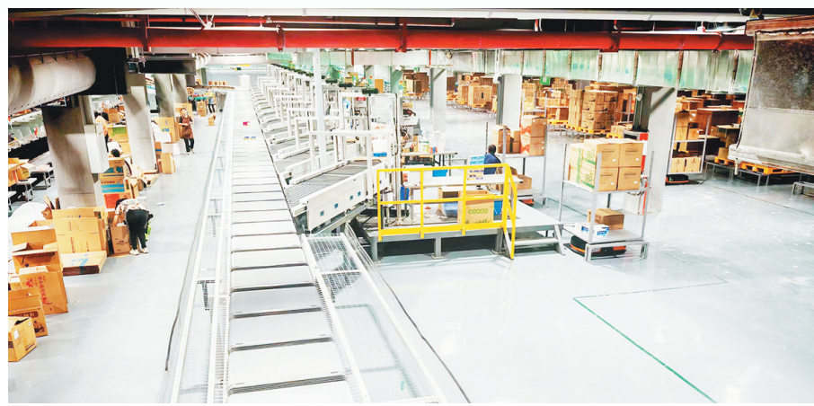
青牛医药5G智慧云仓内的自动拣货交叉分拣机正在流水作业
