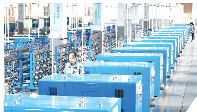
▲在江西正导精密线材有限公司绞线车间，工人们正在调试高速绞线机参数。
