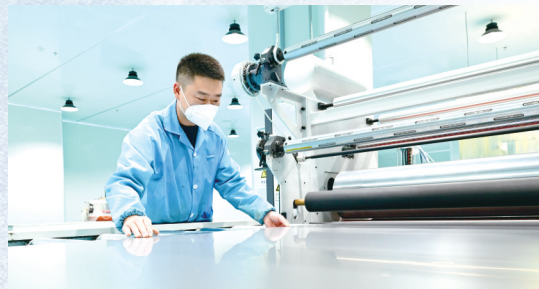
▲江西省爱慕科技有限公司是一家以研发、生产新型投影显示技术为核心的科技企业，年产30万片菲涅尔抗光屏幕。在贴合车间，工人通过全自动液体胶贴合机，将菲涅尔光学膜贴到基板上。
