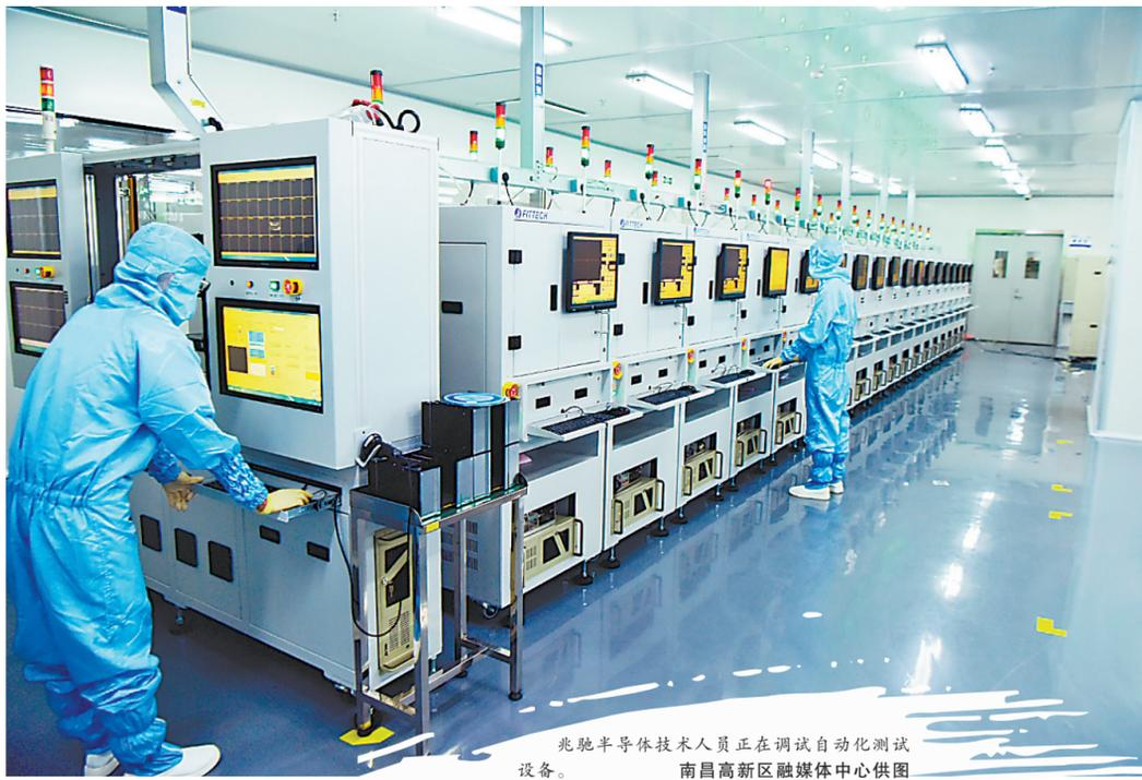
兆驰半导体技术人员正在调试自动化测试设备。南昌高新区融媒体中心供图
