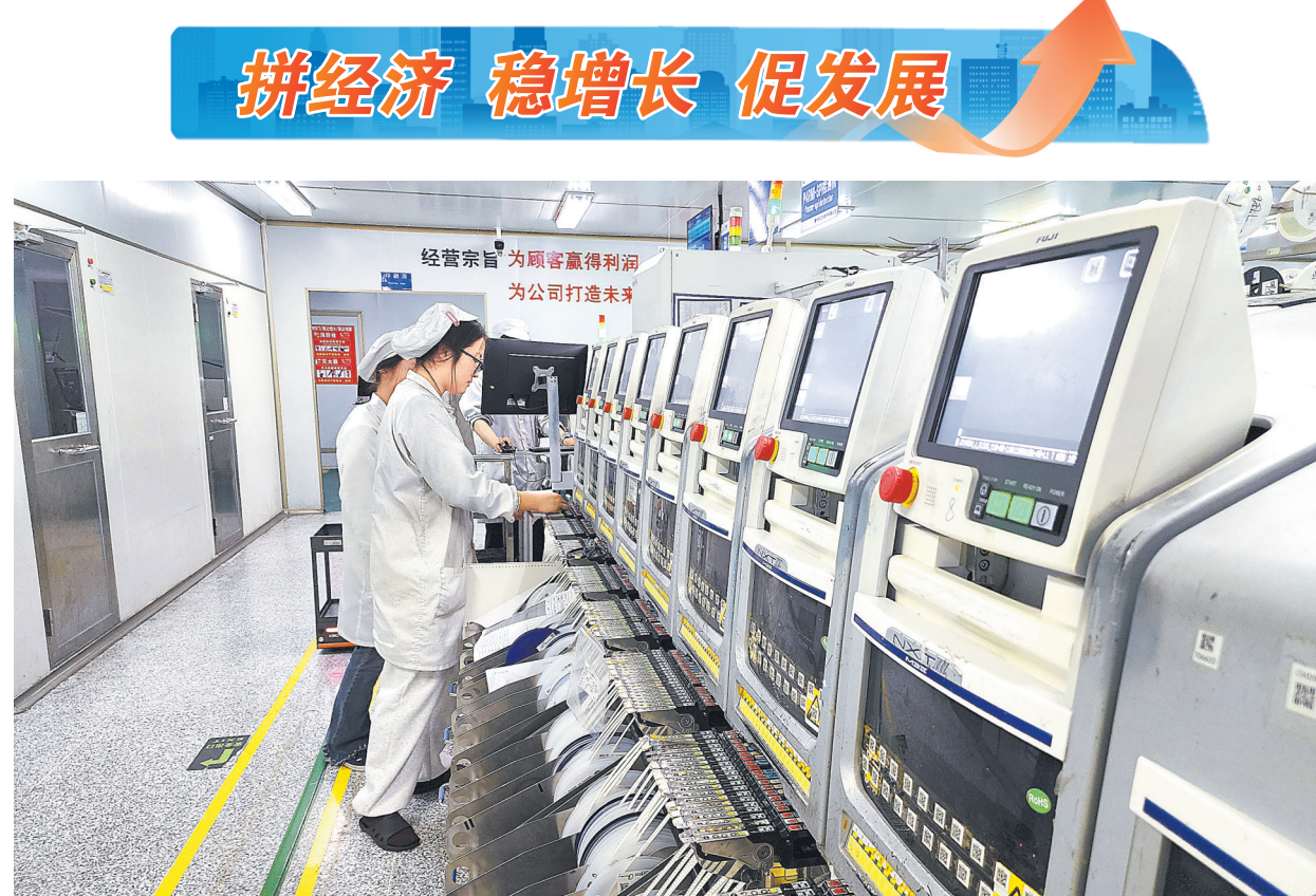
赣州市江元电子有限公司建设智慧工厂,设备数控化率达90%,实现现场管理精度从天数级别到每秒级别。图为12月5日,该厂技术人员进行表面组装技术产线生产数据采集。
