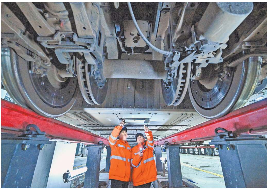
1月12日凌晨,在南昌动车组运用一所,南昌电务段南昌西车载设备车间设备维护人员正在进行数据换装,并对车载系统以及车底相关设备进行“体检”,保障春运期间铁路运输平稳有序。
