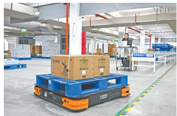
在玉峡医药冷链仓储中心,中药饮片、健康食品等产品通过AGV叉车、AGV智能分拣车,送至分拣工作站。
