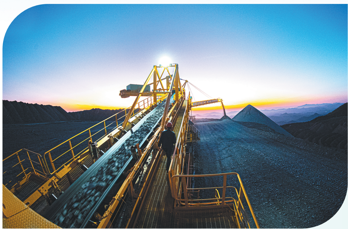
江铜集团德兴铜矿废石胶带生产现场 张伟峰摄
