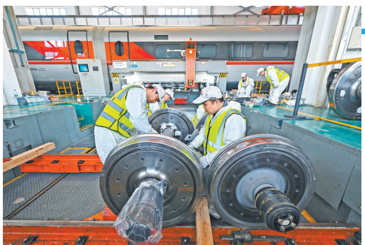
2月25日，工作人员在试验中心对动车组样车进行试验验证时更换轮对作业。 新华社记者 李鑫摄
