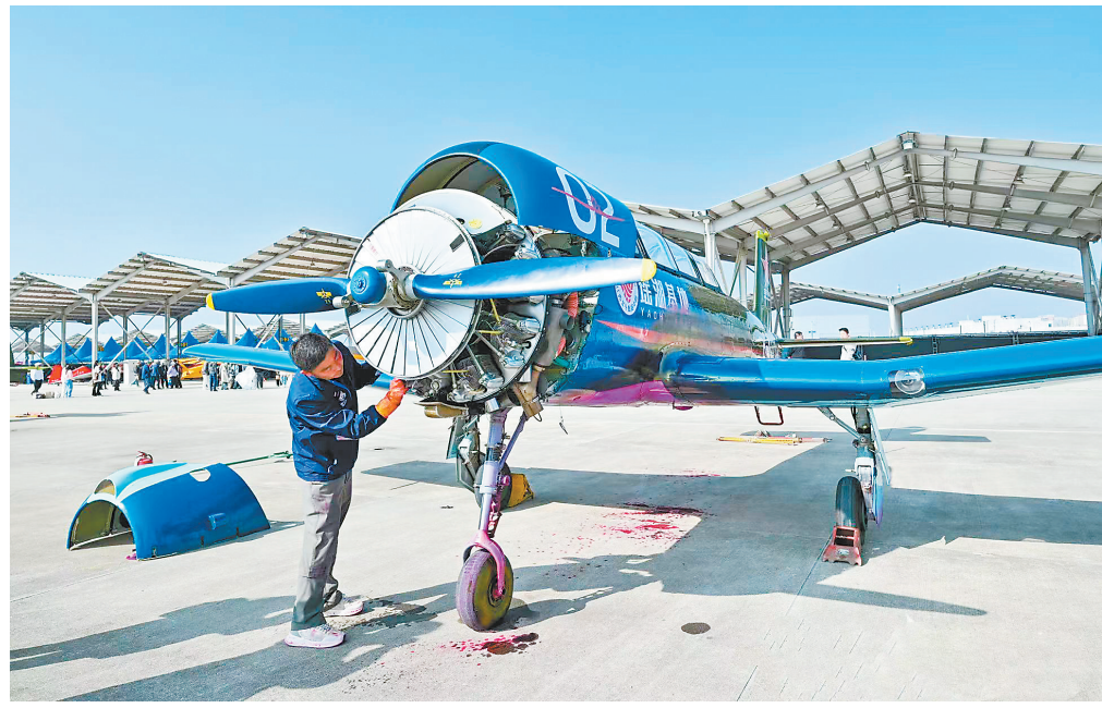
图为南昌瑶湖机场的工作人员对初教-6螺旋桨初级教练机进行组装调试。本报全媒体记者史港摄
