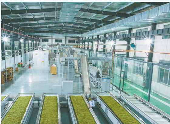
庐山市通过扶持制茶龙头企业，茶叶生产工艺更加现代化、智能化。图为近日，东林雨露现代农业有限公司生产车间内，工人在揀青槽边查看茶叶揀青程度。
