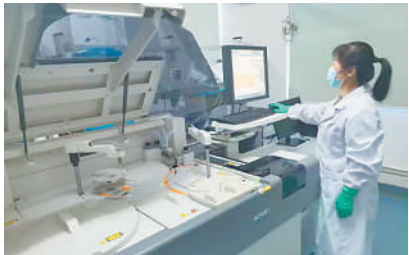
省医疗器械检测中心检测人员正在进行医疗器械生物学评价亚急性性试验临床检测
