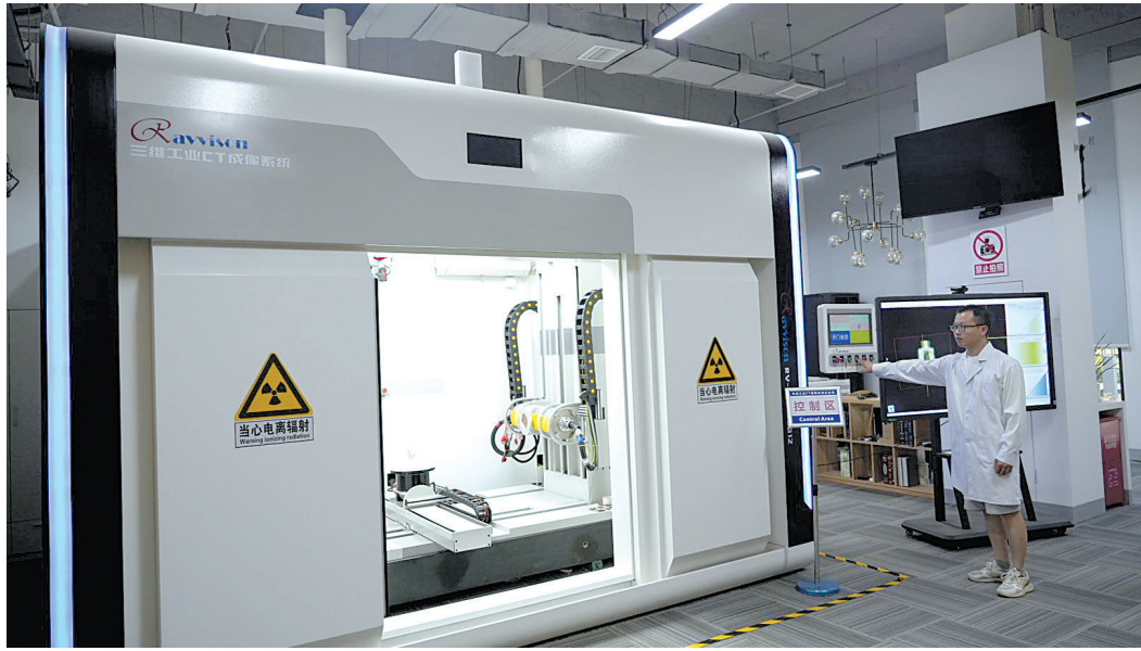
7月24日，北航江西研究院工作人员正在操作工业CT成像设备，对一件新生产的汽车零部件进行“体检”。
