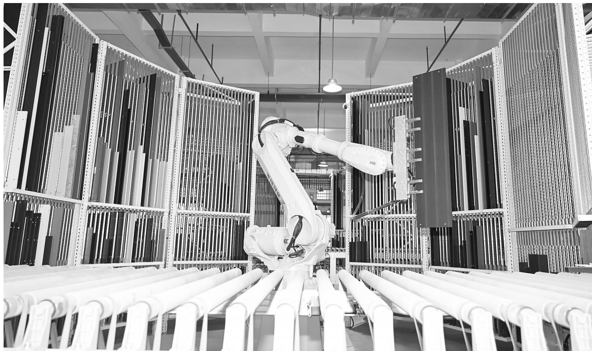
近年来,赣州市南康区通过引进优质项目推动家具产业转型升级,向全屋定制、智能家居等领域延伸。图为近日,圣蒂斯堡(赣州)智能家居有限公司生产车间内,机械臂正高效分拣板材。 本报全媒体记者 张翰林摄
