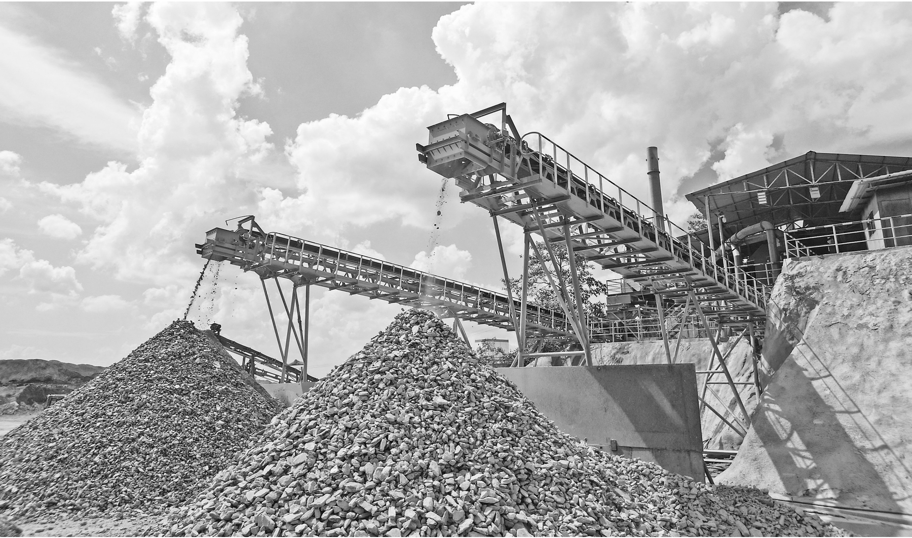
8月22日，在位于德兴市的江西铜业集团银山矿业有限责任公司露天采矿场，光电分选车间机器正在进行矿石与废石分选作业。今年6月，该公司自主科研项目光电分选技术实现工业化应用，标志着该公司在超低品位铜矿石(含铜废石)分选技术领域实现重要突破。该技术项目预计年处理含铜废石30万吨，回收近10万吨有价值资源，创造直接经济效益超千万元，推动矿山资源综合利用水平迈上新台阶。
