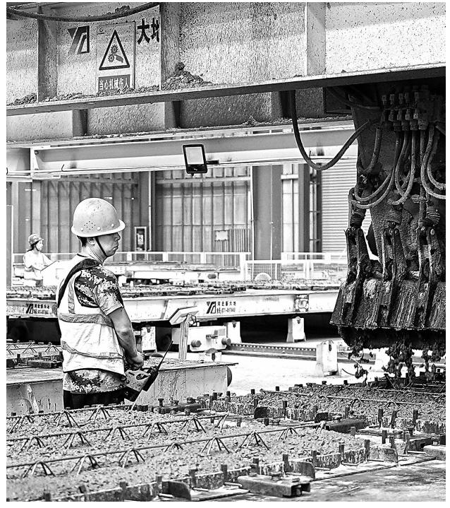
10月10日,赣江新区装配式建筑生产基地内,工人正在操作智能化设备进行混凝土振捣作业。该基地由赣江控股集团等投资建设,集研发设计、构件生产、产学研合作于一体。
