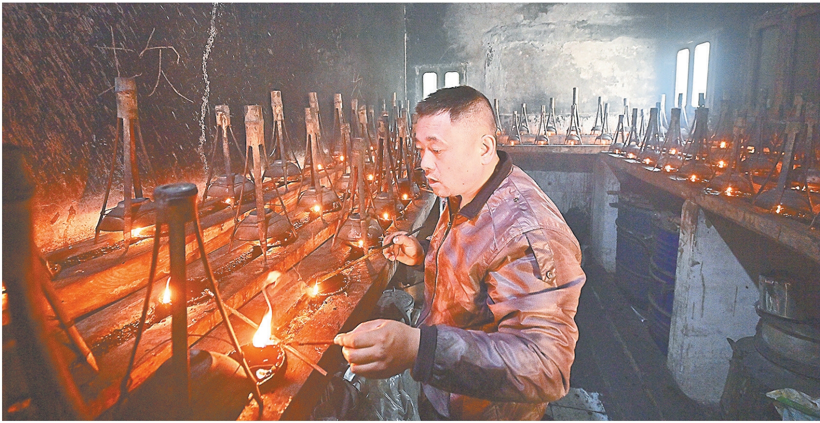
12月2日,婺源县虹关村的詹大有墨庄,省级非遗代表性传承人詹汪平正在烟房内调整油盏灯芯。多年来,他始终坚持人工点烟、牛皮熬胶的制墨古法。
