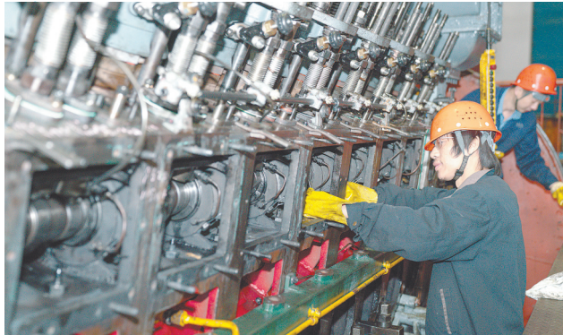
春运来临，中国铁路南昌局集团有限公司南昌机务段工作人员对内燃机车柴油机开展检修，保障春运安全。
