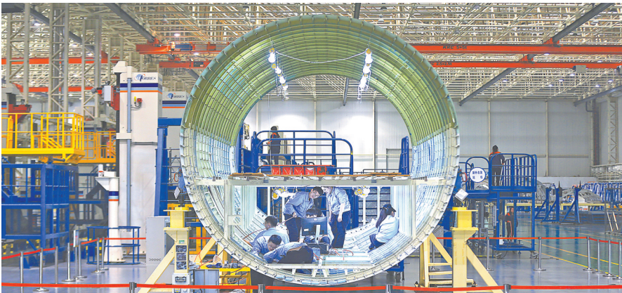
南昌航空城大部件装配厂房里,工人正在组装C919大飞机的机身零件。
