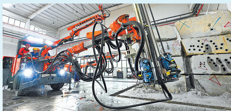
技术人员对即将出厂的凿岩台车进行测试。
