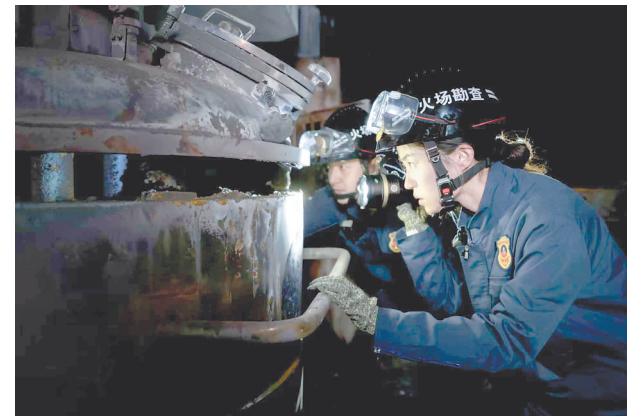
邓雨欣(右一)和同事在某厂房火灾现场勘验设备故障熔痕。 通讯员 张冠男摄
