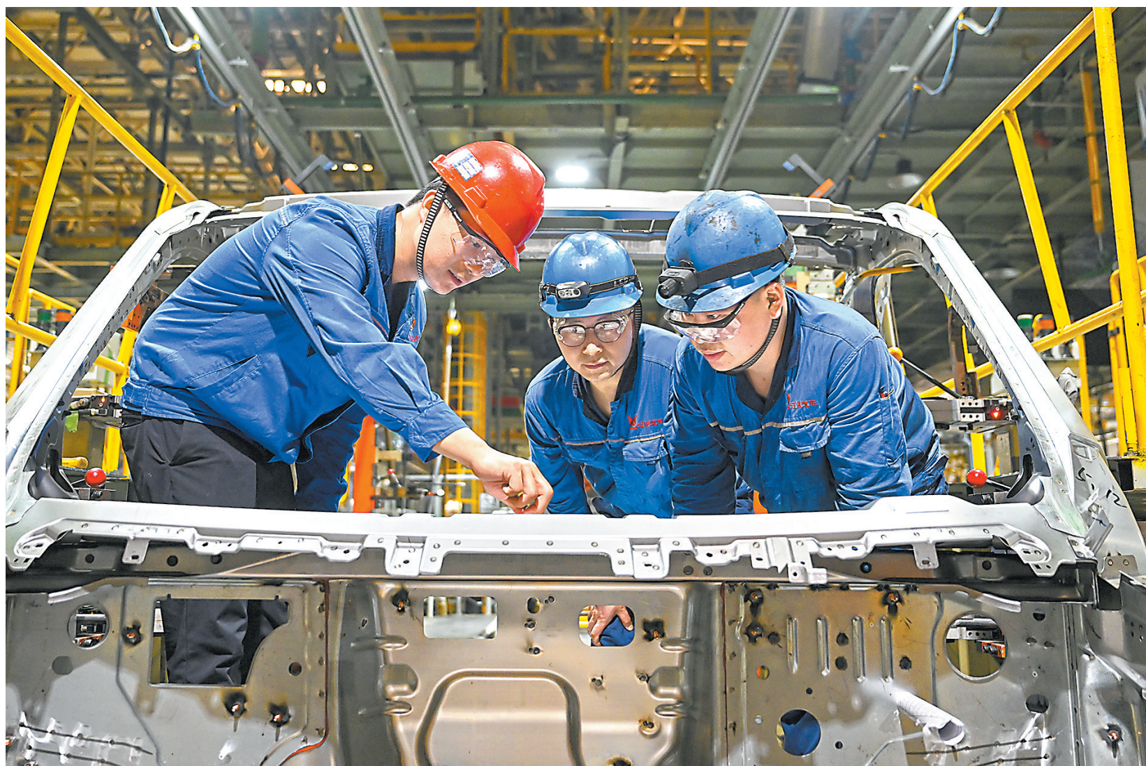
5月12日,江铃汽车股份有限公司小蓝工厂生产车间里,曾祥宗(左)和工友一起检查机器人焊接的质量。
