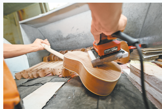
消除接缝毛刺,让箱体线条圆润流畅。
